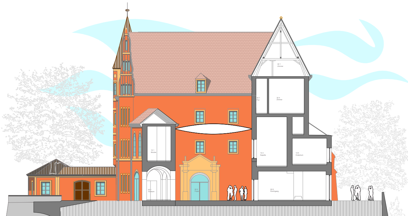
Oben: Fast fertig und bereit für die Aufnahme des Heimatmuseums sind die Räumlichkeiten im 1. OG des Ostflügels. Unten: Schnittzeichnung zur Planung des noch zu überdachenden Innenhofes mit einer transparenten Pneu-Membran-Konstruktion.
